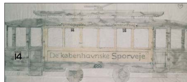
Tegning til spovogn (1910) med den karakteristiske gule farve for høj synlighed og den grå farve til at skjule snavs på udsatte flader.
